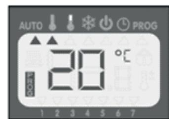
**Modo Auto Confort / Confort:** el calentador funciona permanentemente en la temperatura seleccionada (por ejemplo, 20 °C). La temperatura seleccionada puede modificarse en cualquier momento.
