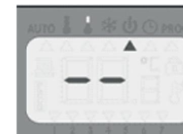
**Modo espera:** estando el equipo conectado a la alimentación eléctrica, en este modo se mantiene apagado.
