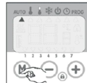
**Selección del modo:** seleccionar el modo de funcionamiento del radiador, de acuerdo a las necesidades de climatización, mediante pulsaciones sucesivas a la tecla M.
