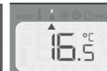
**Modo Eco:** modo de ahorro, 3.5 °C por debajo de la temperatura fijada en el modo Confort. (Por ejemplo, Confort = 20 °C, Eco = 16.5 °C).
